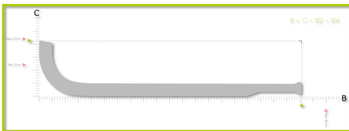
Dessin N° 4 - Illustration des dimensions d'une crosse de gardien de but.
